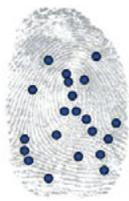
Aus dem eingescannten Fingerbild werden sogenannte Minuzien heraus gefiltert und ...
